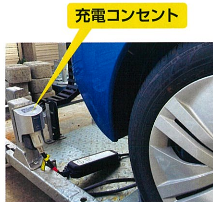
充電用操作盤
